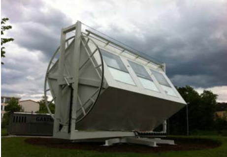
Abbildung 1 Versuchsanlage für Fassaden an der Hochschule Rosenheim
