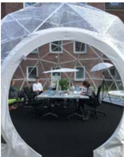
Abb.: Der »LightDome« ist ein Forschungsprojekt der HAWK Hildesheim und simuliert die Situation eines Büroarbeitsplatzes unter freiem Himmel. Die Studierenden messen dort über den gesamten Tag die Veränderungen in Bezug auf Lichtdosis und Lichtqualität und untersuchen die Auswirkungen von dynamischem Licht auf Wohlbefinden und Gesundheit. Der »Light Dome« wurde der Öffentlichkeit erstmals auf der Zukunftskonferenz Licht (ZK 19) vorgestellt.
