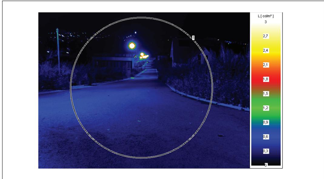
**Abbildung 3-5:** Zusammenfassung des photopischen (links oben) und des skotopischen (rechts oben) Leuchtdichtebildes zum Bild mit der äquivalenten mesopischen Leuchtdichte entsprechend des verwendeten Modells; alle Bilder dieser Abbildung mit logarithmischer Skalierung
